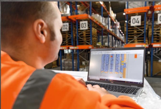
Links: Die dreidimensionale Karte des Linde Warehouse Navigators zeigt das komplette Lager und die aktuelle Position jeder Ladeinheit an. Unten: Vom ersten Scan der Labels an sind die Paletten mit dem System „verheiratet“, also im Linde Warehouse Navigator erfasst.
