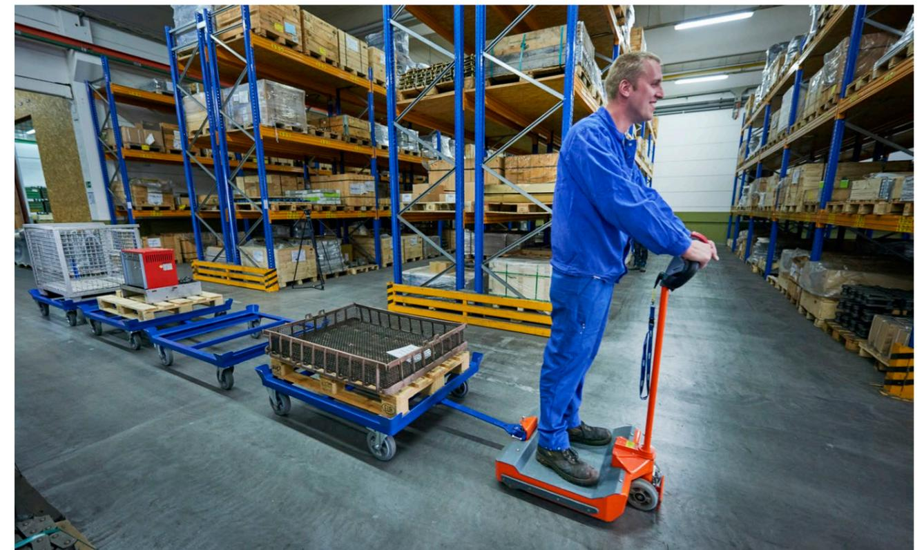
**i** Die Paletten-Fahrgestelle von ROLL CART dienen zur Aufnahme von Flachpaletten, Gitterboxen oder anderen Klein- oder Großladungsträgern. Um eine bestmögliche Spurtreue zu gewährleisten, sollte das Zugfahrzeug über eine Frontlenkung und Zugdeichsel verfügen.
