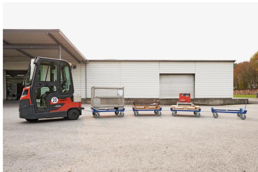
**i** Die Paletten-Fahrgestelle können sowohl im In- als auch im Outdoorbereich eingesetzt werden. Um einen bestmöglichen Fahrkomfort zu garantieren und das Ladungsgut stoßdämpfend zu transportieren, werden vorzugsweise Räder mit Elastik-Vollgummibereifung eingesetzt.
